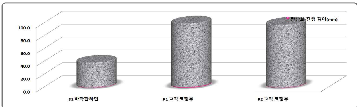
[그림 11.3.6] 탄산화깊이 및 잔여피복두께 측정결과
